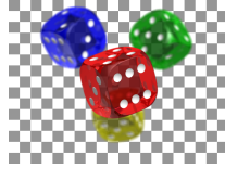
Рис. 1.16. Визуализация изображения в формате PNG с 8-битным каналом прозрачности («шахматный» фон обычно используется в графических редакторах для обозначения «прозрачного» фона)
